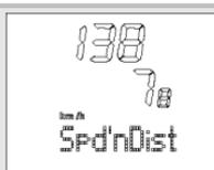
Как только Вы попадаете в меню **Spd'nDist**, пульсотактограф автоматически переходит на основную индикацию. Она показывает в средней строке текущую скорость. Нижняя строка указывает среднюю частоту пульса.
